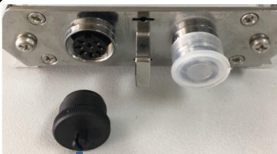
①取下天线上的AISG接头保护盖。
